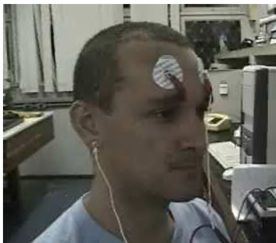
Fig. 1 - Posicionamento dos eletrodos de superfície para captura da piscada dos olhos.
